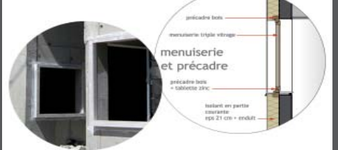
Détails constructifs BBC
